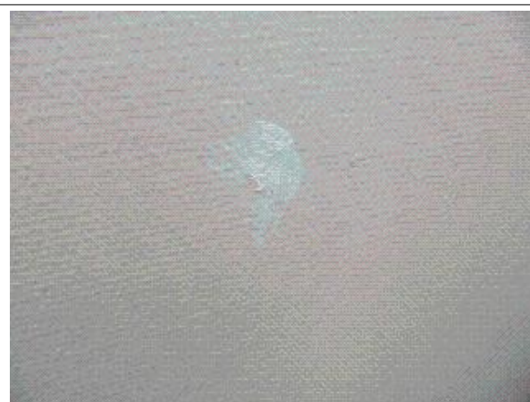
Prélèvement - P22 : BAT L0 / RDC / SANITAIRES - Enduit- (Absence d'amiante)
