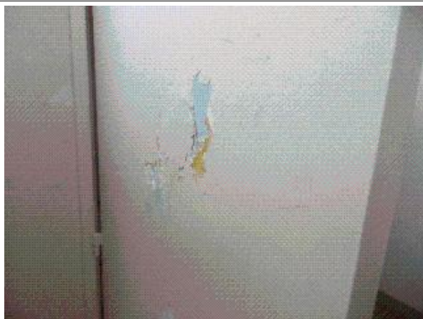
Prélèvement - P19 : BAT L0 / RDC / SANITAIRES - Peinture- (Présence d'amiante)
