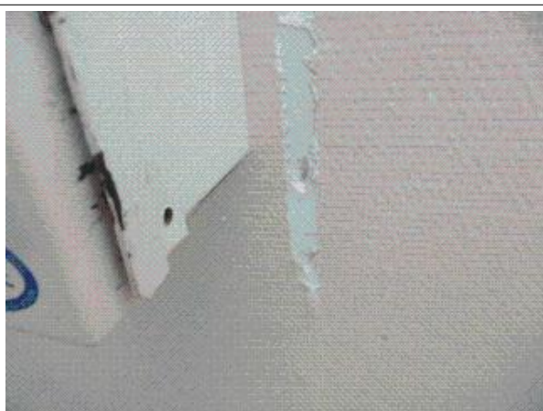
Prélèvement - P21 : BAT L0 / RDC / SANITAIRES - Enduit- (Absence d'amiante)
